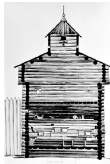
Разрез башни Братского острога. Реконструкция И. В. Маковецкого, Т. А. Лапиной. 1957 г.
