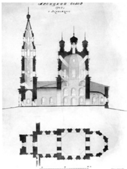
Троицкий собор в Верхотурском кремле. Южный фасад. Разрез. План. Обмеры П. А. Тельтевского
